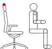
Beim Zurücklehnen werden Nacken- und Schultermuskulatur durch die Kopfstütze entlastet.
