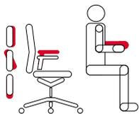
Höhenverstellung zur Entlastung der Hals-Nacken-Muskulatur. Breitenverstellung und Schwenkbarkeit für optimalen Auflagenwinkel, Tiefenverstellung für optimalen Tischabstand.
