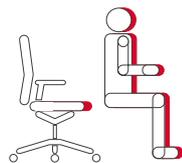
Statt nur die Entfernung zwischen Sitz und Rückenlehne zu verändern, wird bei der Aktiven Sitztiefenverstellung die reale Auflagefläche für die Oberschenkel vergrößert. Das bedeutet insbesondere für größere Menschen eine bessere Verteilung des Körpergewichts auf die Oberschenkel und damit deutlich mehr Sitzkomfort.
