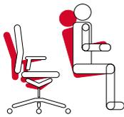
Durch die synchrone Bewegung von Sitzfläche und Rückenlehne wird der Körper in jeder Position optimal abgestützt; der Push-Effekt bleibt aus.
