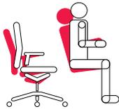
Durch die synchrone Bewegung von Sitzfläche und Rückenlehne wird der Körper in jeder Position optimal abgestützt; der Push-Effekt bleibt aus.
