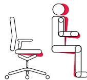
Mehrstufige Verstellbarkeit der Sitzfläche nach vorne wirkt dem Rückkippen des Beckens entgegen. Die Wirbelsäule wird entlastet, der Rundrücken vermieden.
