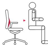
Die horizontal verstellbare Lordosenstütze kann sich an die individuelle Wölbung der Lendenwirbel anpassen; Muskelarbeit wird reduziert.
