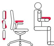
Höhenverstellung zur Entlastung der Hals-Nacken-Muskulatur. Breitenverstellung und Schwenkbarkeit für optimalen Auflagenwinkel, Tiefenverstellung für optimalen Tischabstand.
