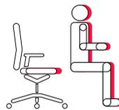
Reguliert den Abstand zwischen Rückenlehne und Sitzvorderkante, und ermöglicht optimale Auflagefläche für die Oberschenkel; auch bei großen Körpergrößen.
