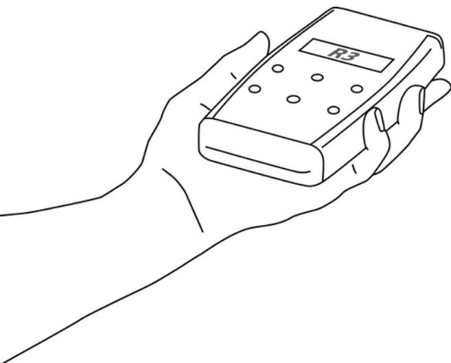
Dank Infrarot können die Signale kabellos gesendet werden. Optional: Die Reihennummernanzeige. Sie wird aufgesteckt und mit einem Spezialwerkzeug wieder demontiert.
